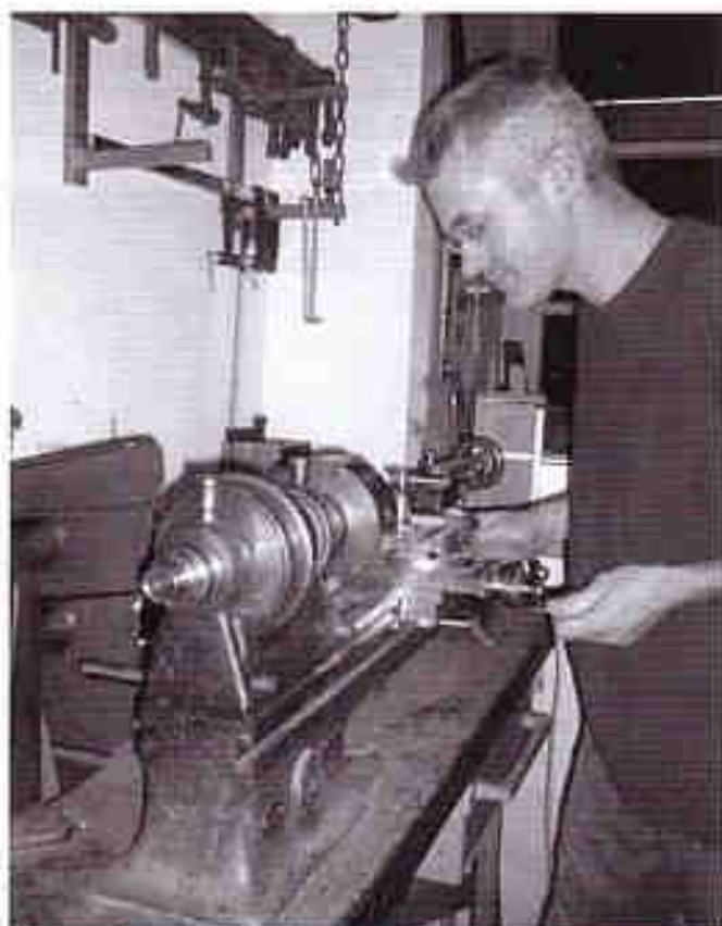
Loin de la production industrielle, l'artisan confectionne patiemment toutes les pièces de l'instrument, ici sur un tour.
